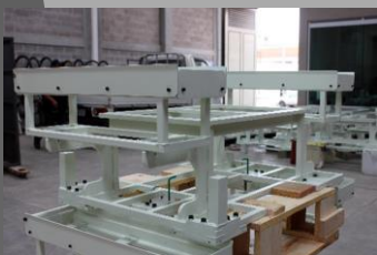
FABRICACION DE DOLLY PARA SUBENSAMBLE DE MOTOR
